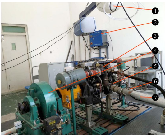
1. 药箱 2. ET-4500型智能油耗仪 3. YN38CRD2型柴油发动机 4. DWD160型电涡流测功机 5. 温度传感器 6. 喷头 7. 尾气能量回收式烟雾机
