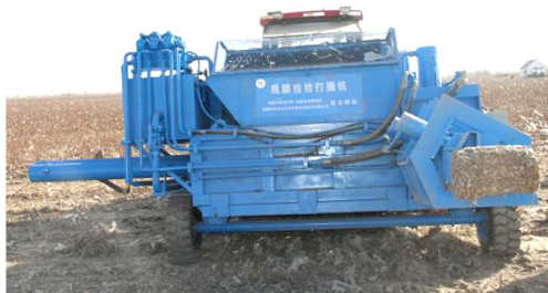
图 17 CMJY-1500 型农田残膜捡拾打包联合作业机
