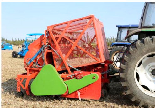
图13 4JSM-2000型秸秆还田弹齿搂膜联合作业机
