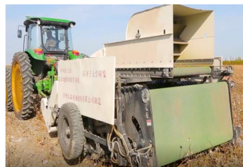
图 20 二阶链板式秸秆还田残膜回收联合作业机
