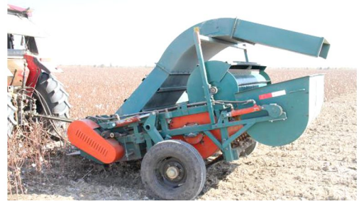
图14 4JSM-2100型秸秆粉碎还田残膜回收联合作业机
