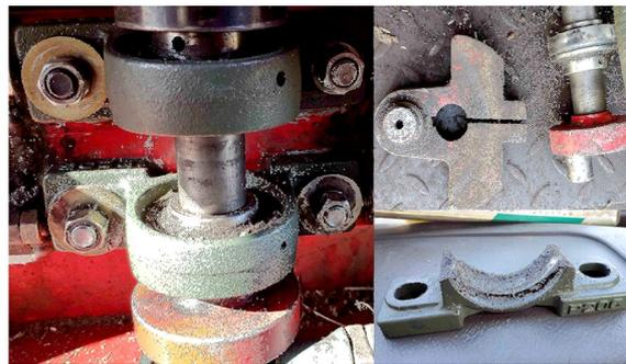
图 13 切割装置固定轴故障现场
